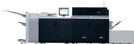
Цветная листовая ЦПМ со скоростью печати до 100 стр./мин, нагрузка — до 1,5 млн отт./мес., бумага — 60–400 г/м<sup>2</sup>; активная приводка листов, встроенный спектральный датчик (ILS) для предварительной настройки цветов на каждой странице; тонер Consistently Vivid (CV) обеспечивает стабильность и точность цветопередачи на широком спектре носителей.
