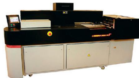
Полуавтоматическая клеевая машина; могут применяться EVA- и PUR-клей для боковой проклейки; подготовка корешка обеспечивается отключаемой прецизионной фрезой, глубина фрезерования регулируется с панели управления; опция для приклейки полосок к корешку книги позволяет делать книги профессионального качества; опционально возможно производство книг в твёрдом переплёте благодаря регулируемой высоте секции обжима обложки.
