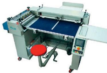
Крышкоделательная машина с горячим и холодным клеем; плотность покровного материала — 80–400 г/м<sup>2</sup>; производительность — до 120–150 крышек/ч; опционально: автоматическая система поддержания заданного уровня вязкости клея, работа с малым форматом до 60×180 мм, подсветка центральной линии позиционирования.
