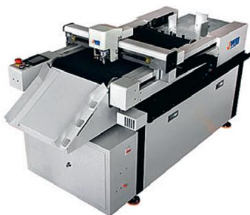
Планшетный плоттер с рабочим форматом до 600×400 мм, скорость резки — до 800 мм/с; для единичных, коротких и средних тиражей наклеек, промупаковки, изделий из бумаги, картона и виниловой плёнки; автоматическая загрузка и выгрузка материала; вакуумная подача, высота стопы — до 10 см; два держателя инструмента на головке; автоматическая загрузка задания при сканировании QR-кода; оптическая система позиционирования по меткам; совместимость с CAD-программами, Adobe Illustrator, CorelDRAW, InDesign.
