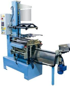
Книгоставочная машина для горячего клея предназначена для вставки блоков в переплётные крышки; полуавтоматический и автоматический режимы; формат — до 350×350 мм, толщина блока — 8–60 мм, производительность — до 10 книг/мин.
