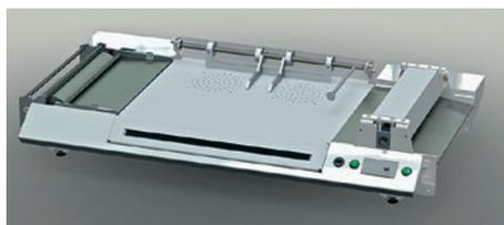
Крышкоделательная (кашировально-переплётная) машина с холодным клеем в настольном исполнении; формат изделий — от 35×35 до 360×700 мм; подсветка точного позиционирования корешка; 4 составных упора; быстроразъемные магнитные упоры; электропитание 220 В; вакуум без компрессора; порт USB-зарядки для телефона.
