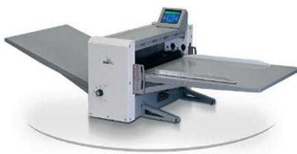
гармошка, шубер, кругление и квадрчение корешка: для этих программ аппарат сам измеряет лист и автоматически рассчитывает координаты линий биговки.
