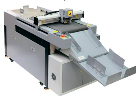
Универсальный планшетный режущий плоттер с автоподачей, скорость — 800 мм/с, рабочая область — 600×400 мм; резка, надсечка и биговка за 1 проход; автоматический старт работы по QR-коду; привода по меткам и компенсация искажения и смещения изображения; совместимые материалы: бумага, заламинированная бумага, самоклеящиеся, синтетические.
