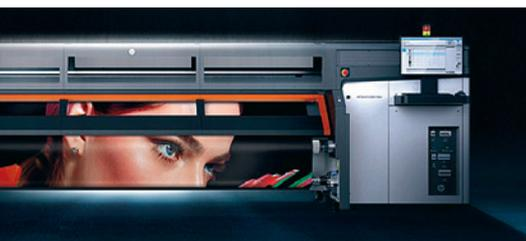
Новый HP Stitch S1000 позволяет печатать напрямую на ткани или на сублимационной бумаге. Производитель уверяет, что печатающие головки HP с физическим разрешением 1200 dpi и система HP Drop&Dry обеспечивают глубокий чёрный цвет, яркие цвета и исключительное разрешение печати.
