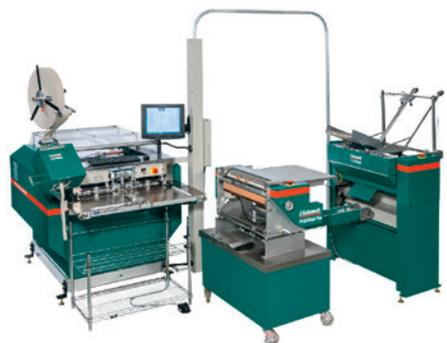
Инновационный комплекс для оперативного изготовления переплётных крышек по требованию от одного экземпляра; автоматическая настройка и управление параметрами по штрихкоду; макс. формат переплётной крышки 400×660 мм, производительность 4 шт./мин. Предназначен для цифровой печати, выпуска фотокниг и альбомов.
