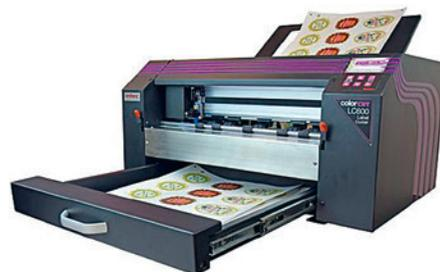
Автоматическая режущая система с податчиком, который вмещает до 250 л. стандартных форматов от А4 до SRA3, а также нестандартных форматов с макс. размером по длинной стороне 750 мм; камера с высоким разрешением для приводки; компенсация перекоса до 5 мм; автоматическая загрузка задания резки по QR-коду; скорость резки — 960 мм/с; вакуумный прижим.
