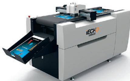
Планшетный режущий плоттер с полностью автоматизированной системой для фигурной резки, надсечки, биговки и перфорации листовых материалов форматом до 1200×900 мм и толщиной до 10 мм; транспортный конвейер с вакуумным прижимом и вакуумным механизмом подъёма листов из стопы для подачи в зону резки; камера высокой чёткости обеспечивает точное позиционирование материалов в автоматическом режиме и прецизионную контурную резку; система запуска резки по штрихкоду.
