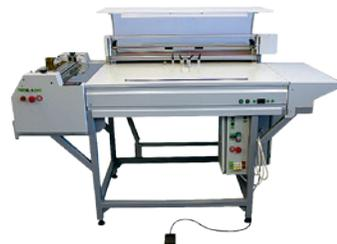
Высокоавтоматизированная полуавтоматическая крышкоделательная машина; регулировка крутящего момента автоматической загибки канта; свободные руки оператора (упоры для лайнера и картона управляются электрическими педалями); регулировка скорости клеевого аппарата и скорости каландрирования; встроенная вакуумная поверхность; двухканальная система контроля температуры.
