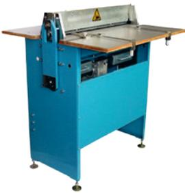
Станок для изготовления перекидных календарей со скреплением типа Wire-O с полным комплексом операций: перфорирование отверстий, высечка углублений под ригель, вставка гребёнки в календарь (сборка календаря) и загибка гребёнки (скрепление); толщина скрепляемой продукции до 12 мм.
