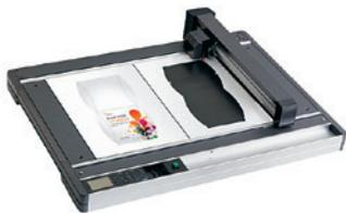
Планшетный режущий плоттер для резки и биговки бумаги и картона насквозь (изготовления упаковки, открыток, конвертов, папок, бумажных пакетов), для надсечки любых самоклеющихся материалов, резки магнитного винила, одновременной резки и отрисовки лекал из электрокартона для текстильного производства; скорость резки — 750 мм/с, область резки — 660×488 мм; электростатическая система крепления листов; предназначен для малых тиражей (до 500 листов).
