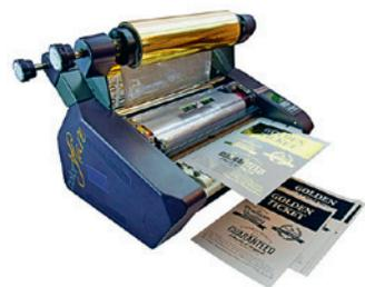
Рулонный ламинатор для фольгирования и ламинации с рабочей шириной 330 мм и скоростью 1,3 м/мин; плотность материалов — 80–350 г/м<sup>2</sup>; регулируемое давление, контроль натяжения; независимое управление температурой для верхнего и нижнего валов; автоматическая остановка для экономии фольги; ревайндер; встроенный обрезчик.
