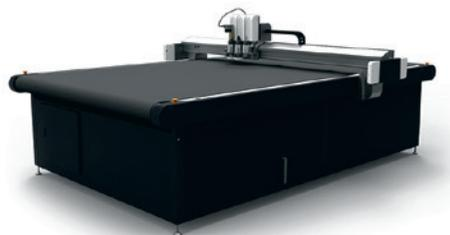
Высокопроизводительный планшетный раскройщик для контурной резки материалов толщиной до 50 мм, перфорации, высечки, биговки, черчения и т. д.; формат резки — 1700×1300 мм; широкий выбор инструмента для обработки разнообразных материалов: пластика, поролона, картона, самоклеящихся плёнок, резины, кожи, ткани. Установки до трёх инструментальных головок одновременно. Скорость резки — до 1500 мм/с.
