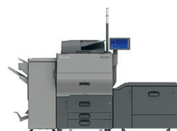
Цветная листовая ЦПМ, позиционируемая для малых и средних типографий. Функция контроля глянца для разных печатных заданий, скорость печати — до 80 стр./мин, пиковая нагрузка — до 450 тыс. стр./мес. Лоток большой ёмкости с вакуумной подачей, улучшенная приводка лица к обороту, печать на носителях до 360 г/м<sup>2</sup>, а также на самокопирующей и фактурной бумаге.
