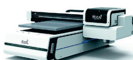
Планшетный сувенирный УФ-принтер с форматом печати 610x900 мм; скорость — 4 м<sup>2</sup>/ч, толщина носителя — до 150 мм; 3 печатающих головки; CMYK + белый/лак; вакуумный стол; печать на цилиндрических поверхностях.
