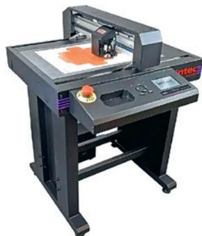
Планшетный режущий плоттер с компактными размерами для небольших коммерческих производств с рабочим полем резки 350×488 мм, скорость резки — 600 мм/с; вакуумный рабочий стол; головка с двумя инструментами для одновременной резки и биговки; оптическая приводка по меткам, компенсация перекоса; опциональный акустический корпус центробежного воздушно-насоса для бесшумной работы.
