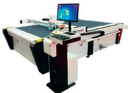
Цифровой планшетный плоттер с рабочим полем 2500×1300 мм, скорость резки — до 1200 мм/с; одновременное использование двух инструментов для макетирования и коротких тиражей; зонирование подвижного вакуумного стола для больших форматов; набор различных инструментов для перфорации, резки, биговки, черчения для работы с разными типами материалов толщиной до 50 мм; сенсорный экран, 6-осевая система сервопривода.
