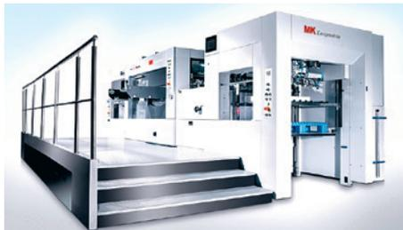
Автоматизированная высекальная машина, скорость — 7700 отп./ч, работает с форматами от 36×40 до 75×106 см; обрабатывает материалы плотностью от 90 до 2000 г/м<sup>2</sup> и гофрокартон толщиной до 4 мм; усилие высечки — 260 т; высокий уровень автоматизации, короткое время переналадки.
