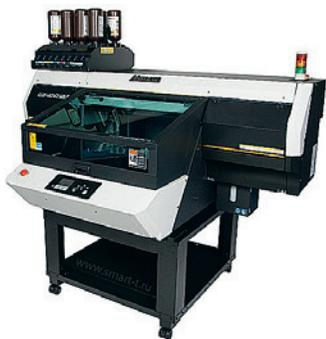
Настольный УФ-принтер для прямой печати на листовых материалах и готовых изделиях толщиной до 153 мм; область печати — 610x420 мм; 4 печатающие головки, расположенные в шахматном порядке; опция Keabab для печати на цилиндрических предметах. Смарт-Т, ст. B1011
