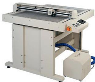
Планшетный режущий плоттер с системой оптического позиционирования для резки материалов толщиной до 1,2 мм; рабочий стол — 76×106 см; скорость резки — до 600 мм/с; выполняет операции черчения, резки, надсечки, перфорации и биговки; каретка с двумя держателями инструментов; резка напрямую из CorelDRAW и Adobe Illustrator.
