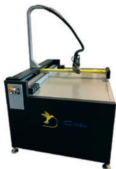
Клеенаносящий плоттер для склейки упаковки из картона для средних производств и изделий малого формата; компактная модель с рабочей зоной 1400×850 мм и скоростью 1,5 м/с; работает с горячим и холодным клеем; 2 независимых рабочих места, возможность объединения рабочего поля в единое пространство; клеевая головка с кавитационной камерой (мгновенное прекращение подачи клея без нитей и хвостов).
