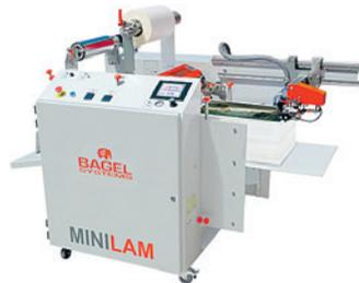
Рулонный ламинатор с автоматической подачей листов и производительностью до 15 м/мин для цифровых типографий; двустороннее ламинирование с двух рулонов на полной скорости; высокая степень автоматизации; технология HotStamp для фольгирования (с фольгой разного типа, в том числе голографической) и лакирования (сплошного и выборочного); устройство автоматического разделения заламинированных листов.
